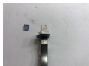
④スペーサー 取り付け
